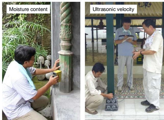
写真3 含水率の計測（左）と超音波伝搬速度計測（右）
